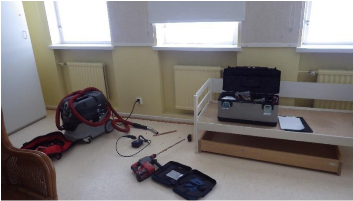
Kuvat 33 a ja b. a) Yleiskuva tilasta 208, mihin tehtiin rakennearaus RA-VP9 poraamalla. b) Poraus kohdistettiin palkin päälle. Endoskoopilla havaittiin palkin päällä olevan 20...30 mm paksu korkkieriste.
